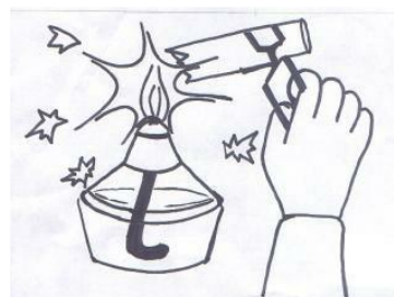
圖十 切勿直接加熱量筒，以免爆破。
