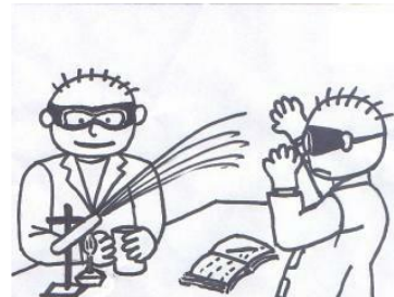
圖九 使用試管加熱時，切勿將試管對著自己或他人，以防止試管內的物質飛濺傷人。
