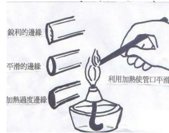
圖七 若有銳利的玻璃管邊緣，可利用加熱方式，使管口平滑。
